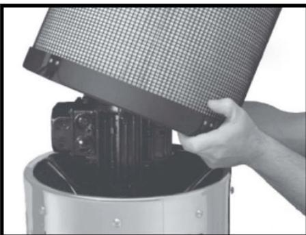
**Paso 4.** Compruebe el filtro posterior (si está instalado) y sustitúyalo si es necesario.
