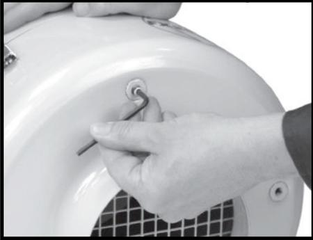
**Paso 1.** Retire los cuatro tornillos de inserción en la base de la unidad.
