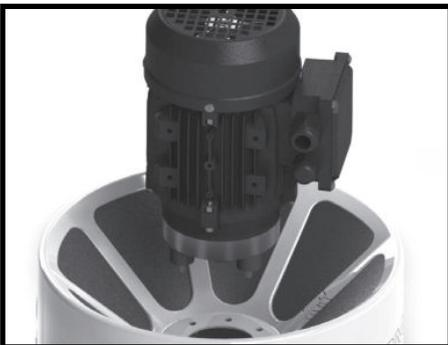
**Paso 13.** Vuelva a montar el motor en la parte superior de la caja.
