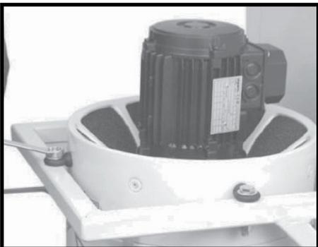
**Paso 4.** Coloque las tuercas de seguridad en las roscas de los cáncamos del interior de la unidad.
