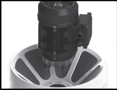
**Paso 10.** Retire el motor de la carcasa.
