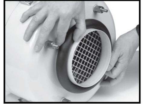
**Paso 3.** Coloque la junta de collarín de espuma alrededor de la espita de entrada (suministrada con la unidad).
