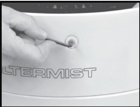
**Paso 1.** Retire los cuatro tornillos de inserción en la parte superior de la unidad a intervalos de 90°.
